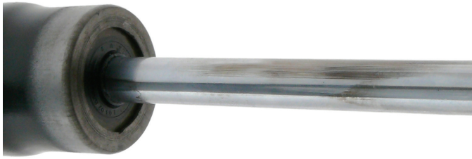
Рис. 1: Модель отказа «Монтаж с перекосом»
