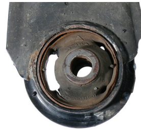
Рис. 2: Дефектная резинометаллическая опора
