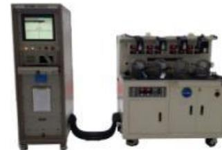
Испытания стартера без нагрузки
