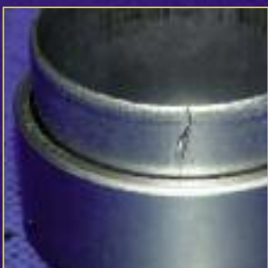
Повреждение кольца при грубой установке
