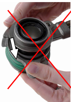
Рис. 1: Уплотняющее кольцо вне направляющей
